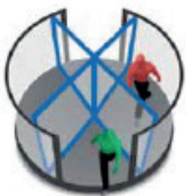
Dør stopper og reverserer så den uautoriserede person gennes ud igen
